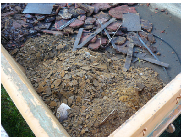
Vorn ungefähr 1,3 t Rost aus dem vorderen Ballasttank, hinten der Fußboden
